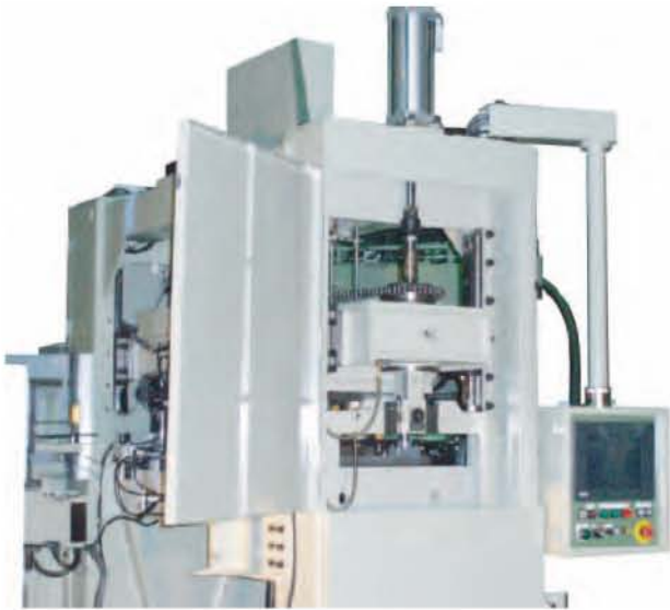
●作業側からの金型交換時
